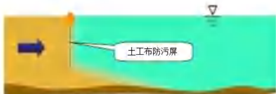
图 9.1-5 土工布防污屏防污机理示意图
