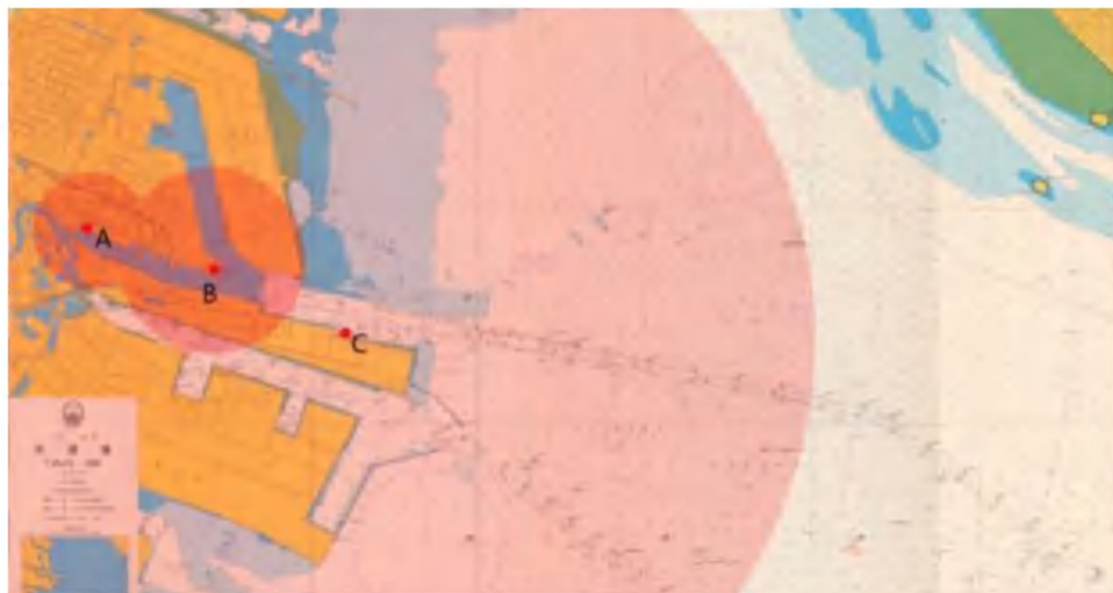
图 4.4-3 远程光电布置位置及监控范围示意图
