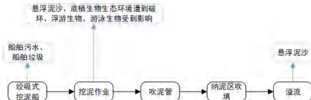
图 5.1-2 绞吸、船吹污染流程图
